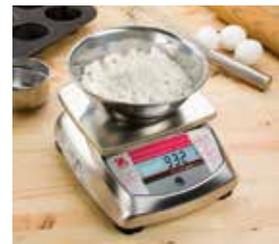
**Bestimmung des spezifischen Gewichts** – Dieser Modus ist ideal für die schnelle und leichte Bestimmung des spezifischen Gewichts einer Probe, ohne dass manuelle Berechnungen durchgeführt werden müssen. Dies ist nicht nur wichtig beim Testen von Stoffen, sondern auch nützlich bei der Überprüfung der Belüftung in Lebensmittelverarbeitungs- und Lebensmittelserviceanwendungen.
